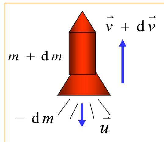
系统的动量为  $p' = (m + dm)(v + dv) + (-dm)(v + dv - u)$
